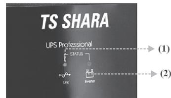
Quando a bateria estiver com um nível baixo, o Nobreak avisará essa condição com um alarme sonoro intermitente que aumentará de frequência conforme a bateria se esgota. Ao final do tempo de autonomia, o Nobreak desligar-se-á automaticamente, protegendo a bateria contra descarga total. Com o retorno da rede elétrica, o Nobreak ligará automaticamente.
